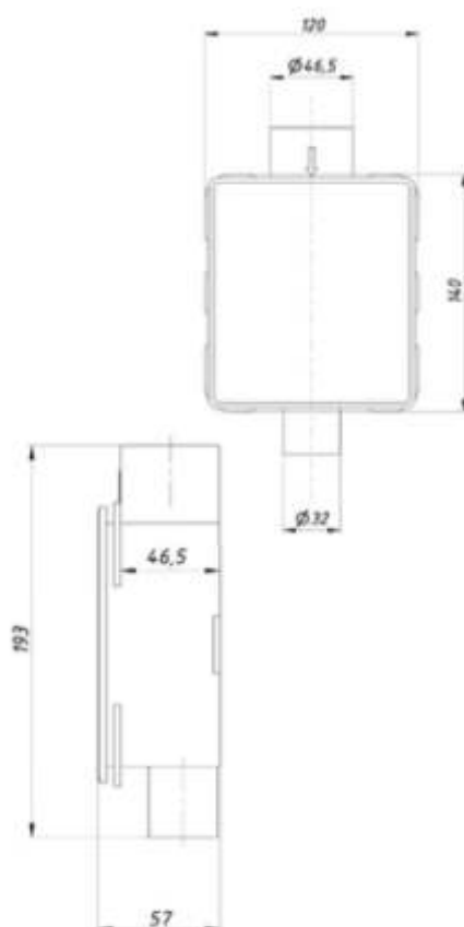
ТП-138 Встроенный сифон для кондиционеров
