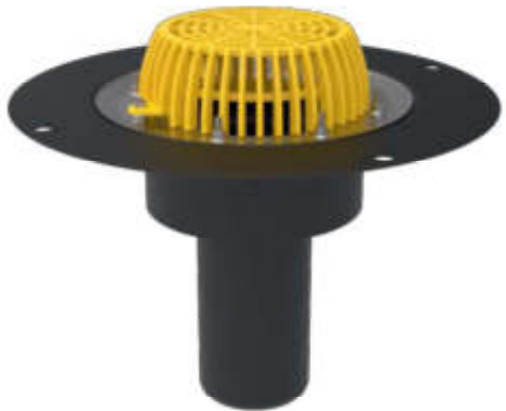
ТП-01.У.100 Воронка с листоуловителем, с прижимным фланцем и вертикальным выпуском 110 мм
