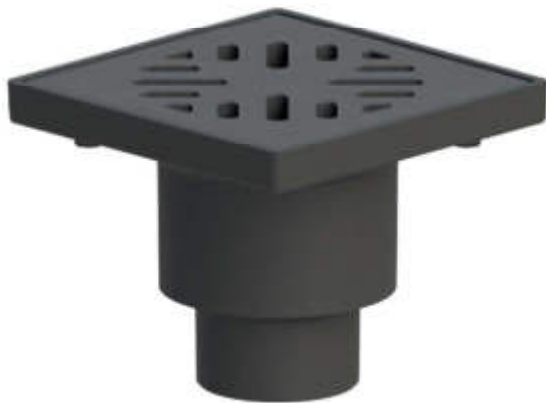
ТП-112.110/160-250VP Трап дворовый с мусоросборником и вертикальным выпуском 110/160 мм
