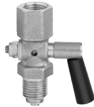
Запорный кран Внутренняя/внешняя резьба G 1/2/G 1/2 B, DIN 16261, PN 25
