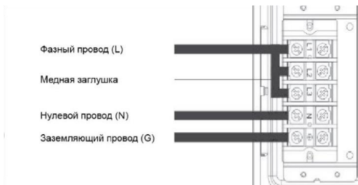
Рис. 8. Однофазное подключение прибора – зеркальный порядок
