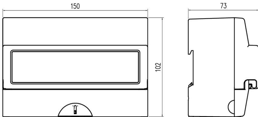
Счетчик устанавливается на DIN-рейку.
