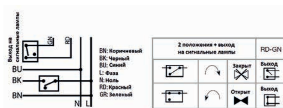
Рис. 22. Схемы электрических соединений привода для зонального клапана с шаровым затвором
