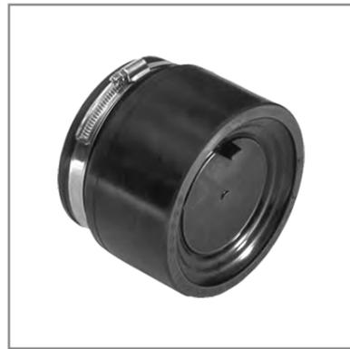
Резиновый манжет из EPDM предназначенный для перехода от SML-систем к другим системам труб из ПВХ, ПП, стали, нержавеющей, керамики и т.д. Имеет внутри две мембраны в виде обратного конуса для надежного и гибкого подсоединения всех существующих типов труб и подводок от сантехнических узлов.
