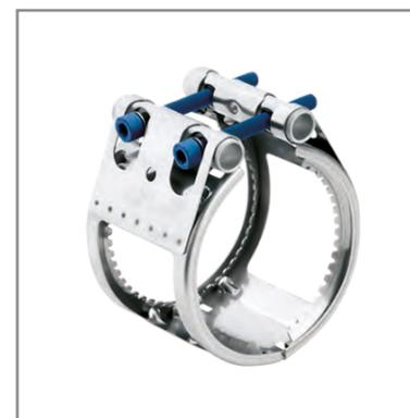
Обжимная манжета кралле для защиты соединения от продольного смещения с высокой растягивающей нагрузкой. Достоинствами хомута являются 2 болта, под шестигранник, что экономит время на монтаже. Поверхность болтов покрыта анаэробным герметиком синего цвета, предохраняющего болты от раскручивания.
