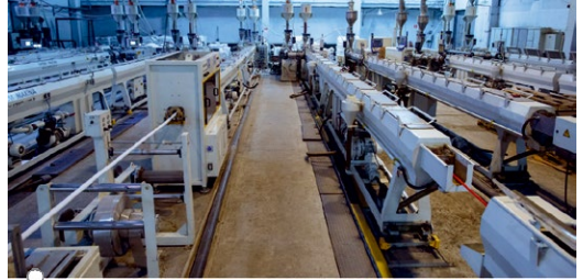
Крупнейший в России трубный цех по производству полипропиленовых и полиэтиленовых труб для систем отопления, водоснабжения
