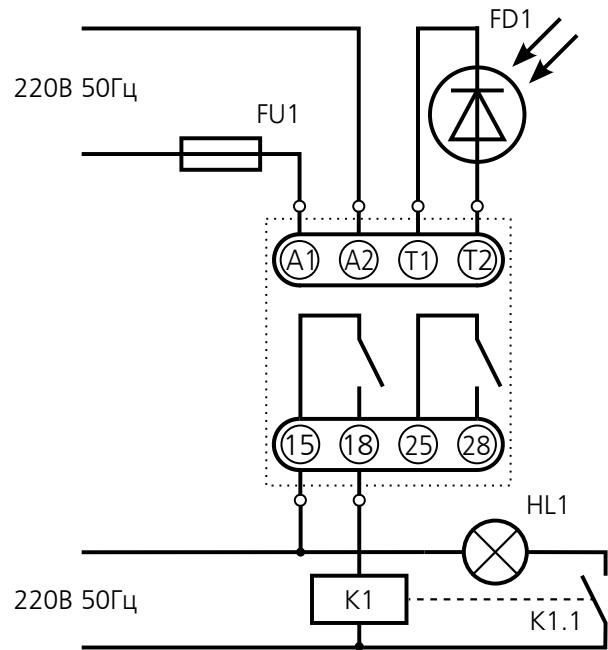
Рекомендуемая схема включения фотореле при мощности нагрузки более 300Вт и ламп ДРЛ
