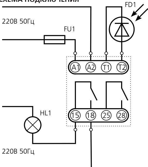
Рекомендуемая схема включения фотореле при мощности нагрузки до 300Вт (исключая лампы ДРЛ)
