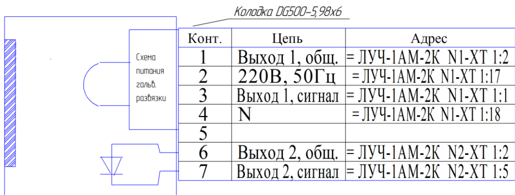
Рис.8. Выходные электрические цепи фотодатчика ФД-05ГМ.
