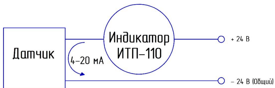
Рис.2. Функциональная схема индикатора ИТП-110.
