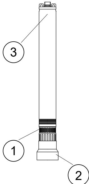
Насосы ECO AUTOMAT представляют собой центробежные моноблочные многоступенчатые насосы с корпусом из нержавеющей стали.
