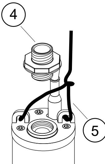
При необходимости удлинения электрокабеля используйте трехжильный влагостойкий кабель, типа H07 RNF, сечением не менее 1  $\text{mm}^2$ .
