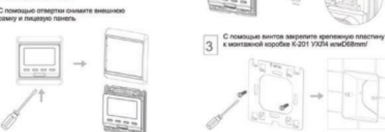
С помощью отвертки снимите заднюю креповую пластину, как показано на рисунке
