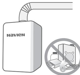
2. Не допускается хранить в помещении, где установлен котёл, химически активные вещества, такие как аммиак, хлор, сера и различные кислоты.
