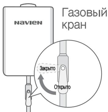
**3. Проверьте положение запорных и распределительных кранов в системе отопления.**
