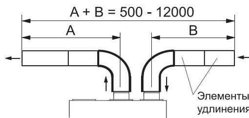
При монтаже раздельной системы дымоудаления, труба отвода дымовых газов всегда присоединяется к центральному патрубку, а труба для забора воздуха присоединяется к правому или левому патрубку, в зависимости от удобства монтажа. Незадействованное воздухозаборное отверстие закрывается специальной заглушкой.
