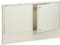
Шкаф коллекторный встраиваемый предназначен для установки распределительных коллекторов диаметров 3/4" – 1"1/4. Шкаф встраивается с стену, устанавливается на пол на опору, возможно регулирование высоты установки шкафа благодаря выдвижным опорам. Крышка шкафа двустворчатая с запорным механизмом.
