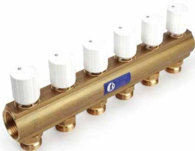
Коллектор со встроенными термостатическими клапанами служит для ручного или автоматического (опция, необходима установка сервоприводов) регулирования мощности отопления. Установленные в коллекторе регулирующие термостатические клапаны позволяют производить гидравлическую регулировку и перекрывать поток теплоносителя. Устанавливать коллектор на обратной магистрали.
