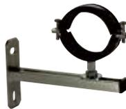
Кронштейн для коллекторов большого диаметра, монтаж на стену, минимальная глубина коллекторной ниши или шкафа 210 мм. Расстояние от коллектора до стены может быть отрегулировано.
