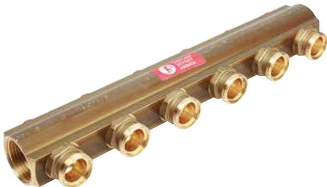
Коллектор со встроенными отсечными клапанами применяют для распределения теплоносителя и балансировки (гидравлической настройки) и перекрытия потока контуров отопления и охлаждения. Возможна установка на подающей и обратной магистралях.
