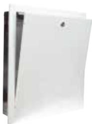
Шкаф коллекторный встраиваемый регулируемой глубины предназначен для установки распределительных коллекторов диаметров 3/4" – 1". Шкаф монтируется в стенной нише и закрывается декоративной рамкой с лючком (дверкой). Также возможно регулирование высоты установки шкафа благодаря выдвигаемым опорам. На внешних стенках шкафа закреплена электросварная сетка для оштукатуривания.
