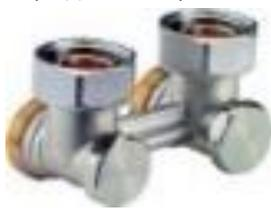
Н-образный узел нижнего подключения стальных панельных радиаторов для двухтрубных систем. Содержит отсечной клапан для перекрытия и балансировки.
