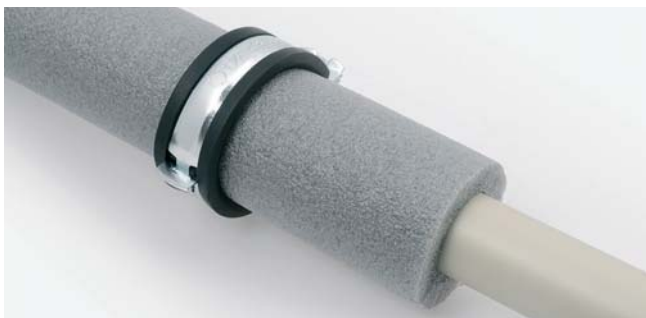
Для транспортировки горячей воды хомут крепится через изоляцию - на размер больше
