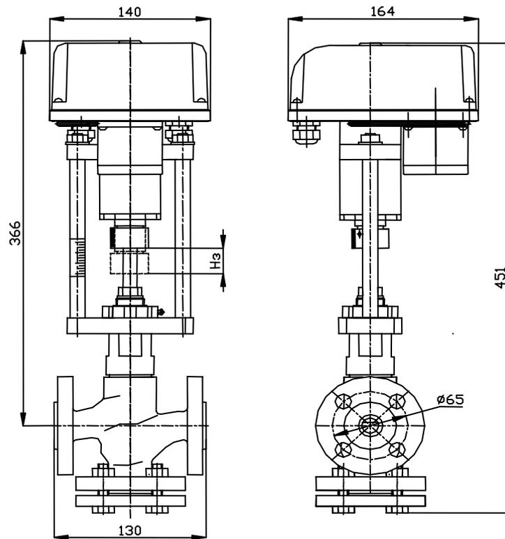
Рисунок 1. Габаритные, установочные и присоединительные размеры клапана.
