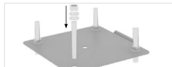
**Шаг 3.** Установите опалубку для верхней части фундамента на высоту не менее 100мм. Нижнюю часть основания (с анкерными болтами) закрепите на доске, опирающейся на опалубку. Анкерные болты должны выступать на расстоянии а) Н = 150мм для квадратного или б) Н = 115мм для треугольного опрокидывающих устройств от будущего фундамента. Ось молниеотвода должна совпадать с осью фундамента.
