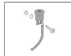
**Шаг 2.** Наконечник тросовый, установленный на конце троса токоотвода соединить болтовым соединением с вершиной молниеотвода.
