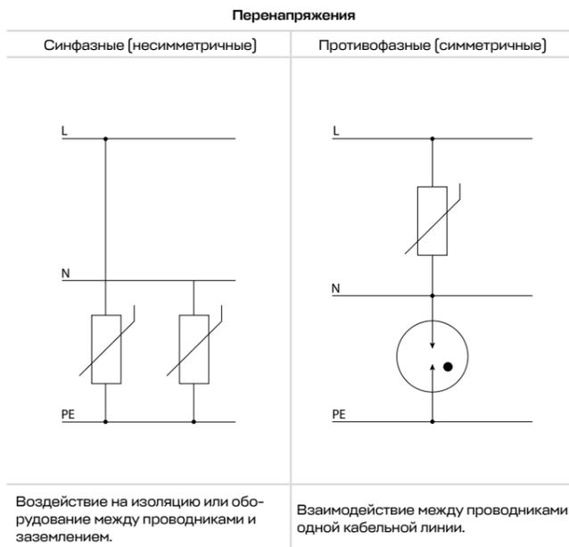
Для сетей TN-S схемы «1+1» («3+1») рекомендуются как максимально подходящие в те моменты, когда источник импульса не известен, а схемы «2+0» («4+0») используются когда импульс перенапряжения развивается от земли.
