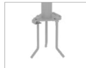
**Шаг 5.** Стоя у молниеотвода со стороны вершины, поддерживая молниеотвод, установите его на гильзу опорной плиты, которая в данный момент находится в разложенном виде. Постепенно приближаясь к основанию, установите молниеотвод в вертикальное положение, соединив гайками на анкерах нижнюю плиту основания с опорной плитой, проявляя осторожность к верхним элементам молниеотвода. Во избежание опрокидывания мачты, закрепите её страховочным тросом.
