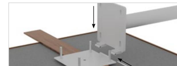
**Шаг 7.** Далее снимите опалубку. Откиньте верхнюю часть опрокидывающего устройства и установите молниеотвод на гильзу основания. Поднимите молниеотвод и закрепите основание гайками, шайбами и шайбами-гровер.
