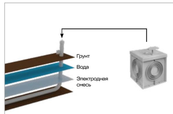
**Шаг 4.** Через верхнюю часть заземлителя, установленную в колодце, добавить воду для начала химической реакции, а также смесь (при необходимости).
