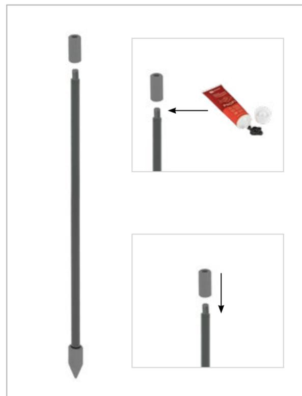
**Шаг 5.** Затем резьба второго штыря покрывается электропроводящей антикоррозионной смазкой и закручивается в муфту до полного контакта с первым штырем. При этом следует обращать внимание на обеспечение полного контакта штырей между собой, что необходимо для уменьшения ударной нагрузки на муфту соединительную и передачи энергии удара непосредственно от штыря к штырю. Второй штырь забивается в грунт.
