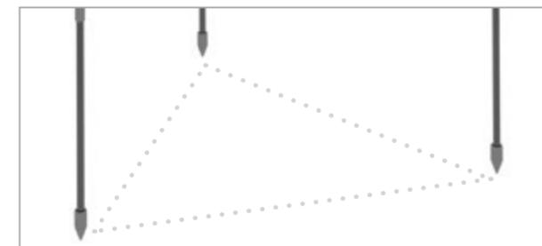
**Шаг 7.** На смонтированные штыри крепятся зажимы штырь-полоса-прут 6 шт. (gc-g3116) и вставляются 3 полосы 4x40x1500 мм из комплекта, образуя треугольник заземления.
