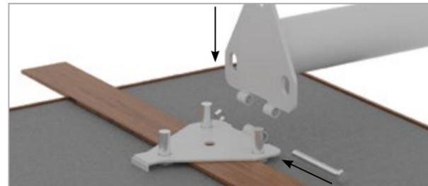
**Шаг 7.** На 14-й день после заливки фундамента снимите опалубку. Откиньте верхнюю часть опрокидывающего устройства и установите флагшток на гильзу основания. Поднимите флагшток и закрепите основание гайками.
