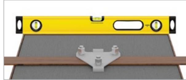
**Шаг 6.** Через 7 дней после заливки фундамента установите верхнюю часть опрокидывающего устройства, закрепив ее осью.
