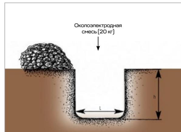
**Шаг 2.** Уложить заземлитель на дно траншеи так, чтобы его короткая часть с отверстием для заполнения была направлена вверх.
