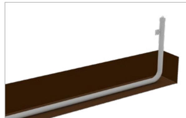
**Шаг 3.** Засыпать траншею и сам заземлитель околоэлектродной смесью (всем количеством, которое идёт в комплекте), залить 40-60 л воды, установить колодец и полностью заполнить грунтом.
