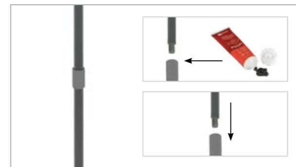
**Шаг 6.** Повторять вышеописанные операции до забивания всех штырей. При монтаже штырей возможно ослабление резьбового соединения муфта-штырь. Рекомендуется периодически подкручивать муфту гаечным ключом № 24, удерживая при этом стержень газовым ключом.
