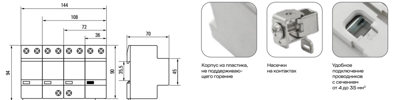
Устройство УЗИП Т1+Т2 предназначено для защиты от прямых ударов молнии в ВЛ или в систему внешней молниезащиты и срабатывает в качестве 2-ой ступени защиты при ударе молнии, позволяя защитить большую часть электронного и электрического оборудования.
