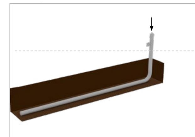
**Шаг 5.** Соединить электроустановку либо систему молниезащиты с электролитическим заземлителем с помощью проводника через зажим, который расположен в колодце в верхней части электрода (заземлителя).
