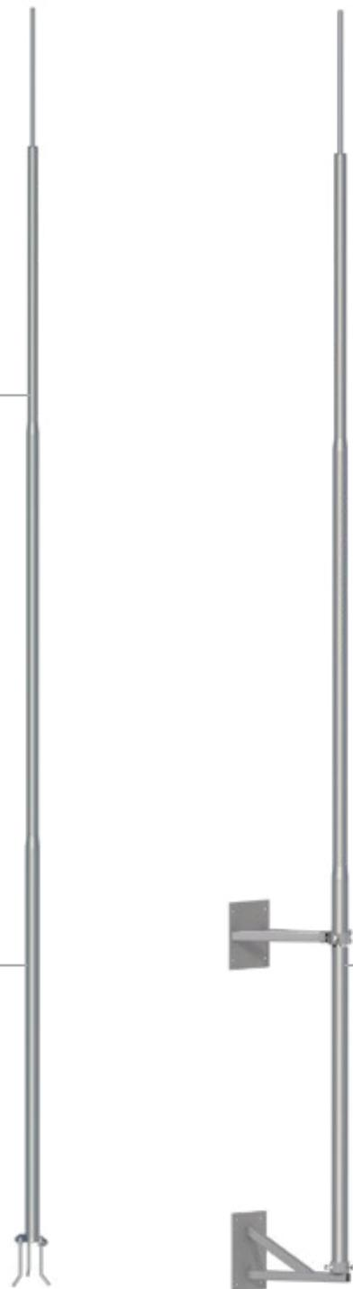
Стеновые секционные молниеприемники
