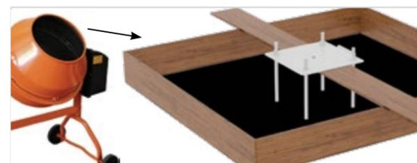
**Шаг 5.** После заливки фундамента проверьте уровнем горизонтальное положение опалубки и нижней части основания молниеотвода.
