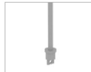
**Шаг 4.** Вкрутите молниеприемник в вершину. Установите вершину в верхнюю секцию и закрепите ее винтами.
