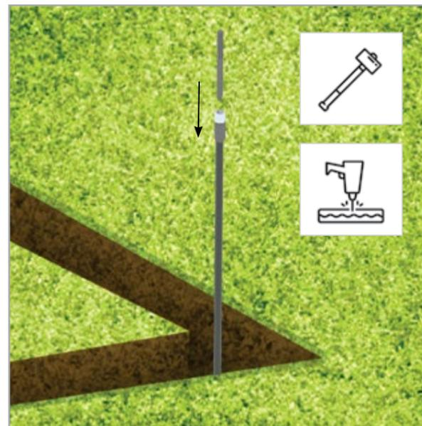
**Шаг 4.** Далее со штыря выкручивается гайка с ударным винтом. На резьбу штыря наносится электропроводящая антикоррозионная смазка и накручивается муфта соединительная D=16 мм HZ EKF (gc-e1302).
