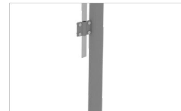
**Шаг 6.** Не забудьте проверить сопротивление заземления согласно главы 1.8 ПУЭ (издание 6 и 7).
