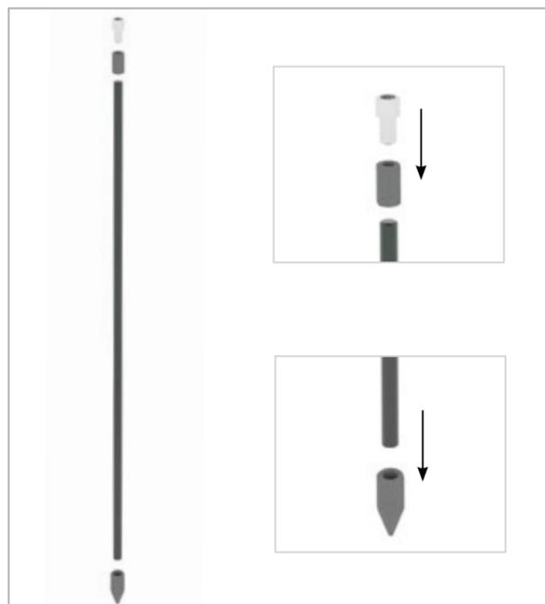
**Шаг 3.** При помощи ручного ударного инструмента (кувалда или перфоратор через насадку SDS-max) штырь забивается в грунт до уровня, удобного для проведения дальнейших монтажных работ.
