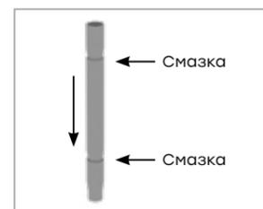
**Шаг 1.** Перед сборкой молниеотвода освободите трубы и аксессуары от упаковки. Расположите секции мачты в порядке сборки на площадке. Пропустите трос токоотвода через все секции мачты. Немного смажьте консистентной смазкой соединительные элементы мачты. Вставьте аккуратно до упора верхнюю секцию мачты в нижнюю. Таким образом соберите все секции мачты.
