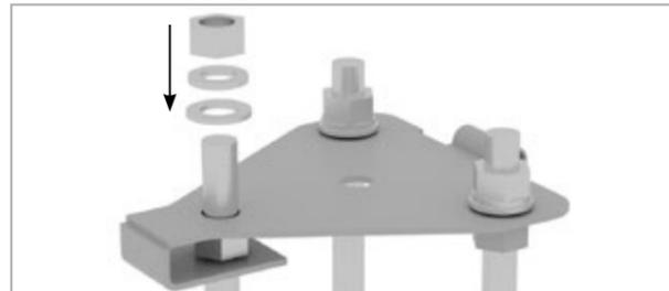
**Шаг 3.** Установите опалубку для верхней части фундамента на высоту не менее 100 мм. Нижнюю часть основания (с анкерными болтами) закрепите на доске, опирающейся на опалубку. Анкерные болты должны выступать на 60 мм от будущего фундамента. Ось флагштока должна совпадать с осью фундамента.
