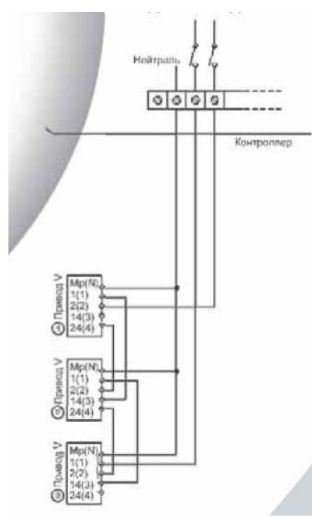
Каскадное подключение электроприводов обеспечивает последовательное управление двух и более электроприводов с помощью одного сигнала от контроллера.
