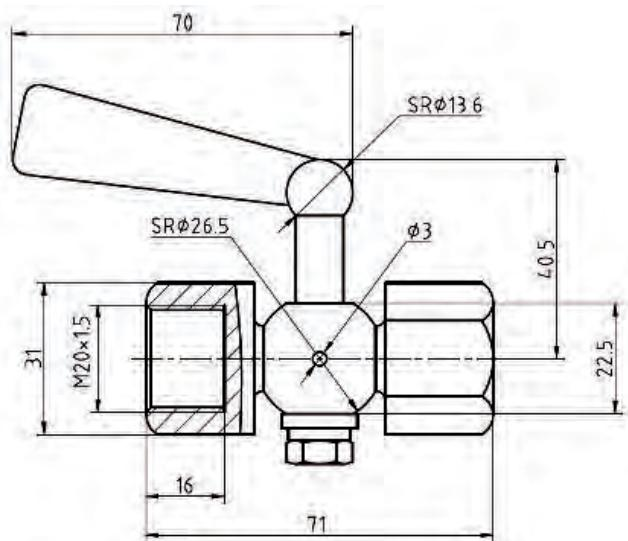
Спецификация деталей, материалов и вес крана трехходового под манометр ABRA KM VFM резьбового (клапана к манометру)
