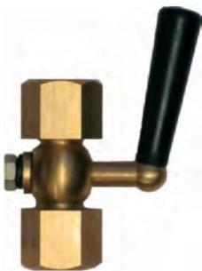
Правила устройства и безопасной эксплуатации сосудов, работающих под давлением, в частности, требуют: "Перед каждым манометром должен быть установлен трехходовой кран или другое аналогичное устройство для продувки, проверки и отключения манометра". Если при соединении с атмосферой стрелка падает до нуля, то вероятность отказа манометра (залипания стрелки) считается минимальной.
