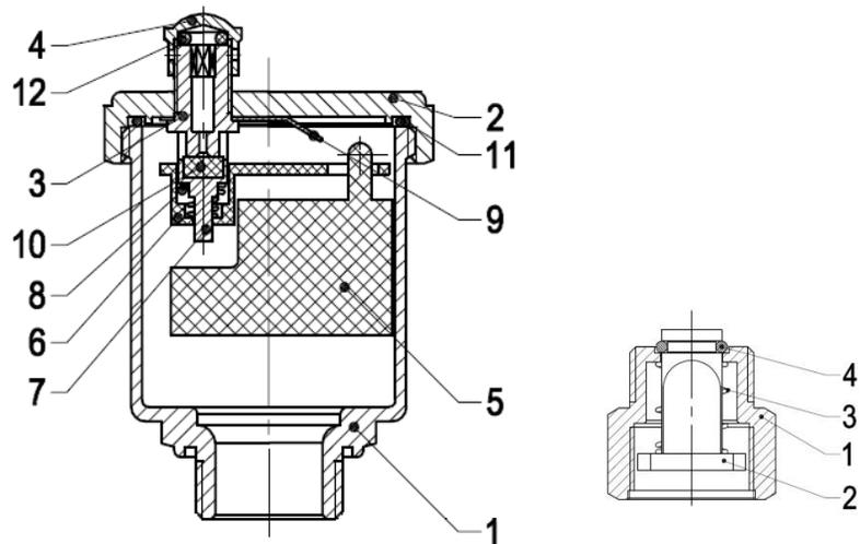
Рис 1. Основные элементы конструкции
